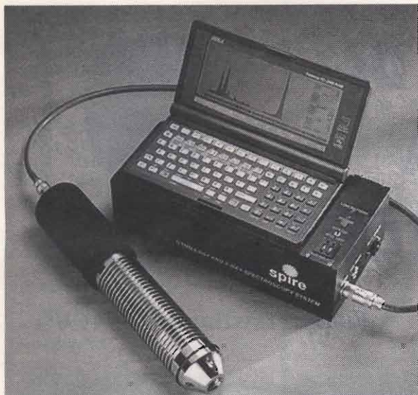
Foto 1 - Spettrometro portatile per raggi X con sonda al Tellururo di Cadmio (CdTe). La sonda (cilindrica) è connessa ad contatore multicanale che funge anche da alimentatore. Il computer palm-top serve solo da interfaccia per la visualizzazione dei dati.
